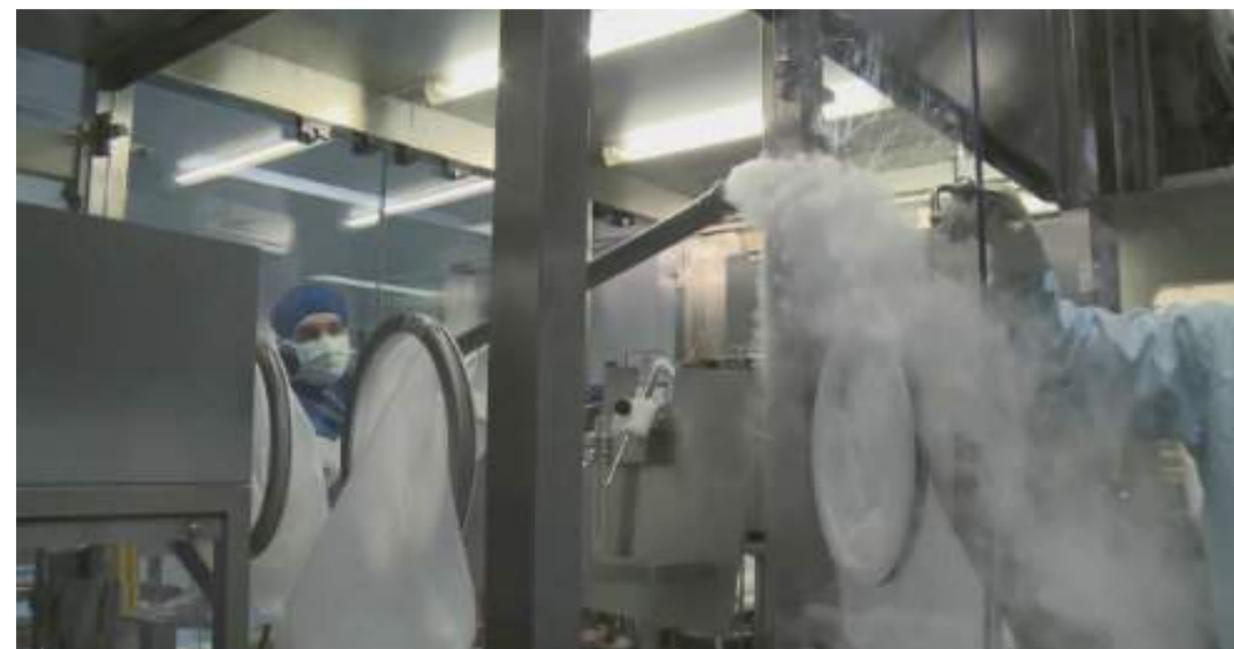
Prüfung auf das Vorhandensein von Keimen in der Umgebungsluft während einer Strömungsvisualisierung (Nachweis, dass die Luft in die richtige Richtung fließt)
